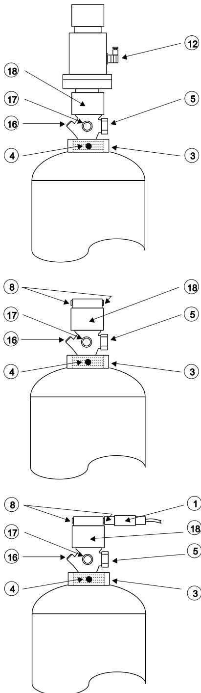
Le valvole B480 sono azionate mediante dispositivi di azionamento elettrici o pneumatici posti sulla valvola. Il dispositivo di azionamento elettrico deve essere ripristinato dopo un intervento per mezzo del dispositivo di serraggio. In caso contrario la valvola si attiva immediatamente al momento del montaggio del dispositivo di azionamento.
