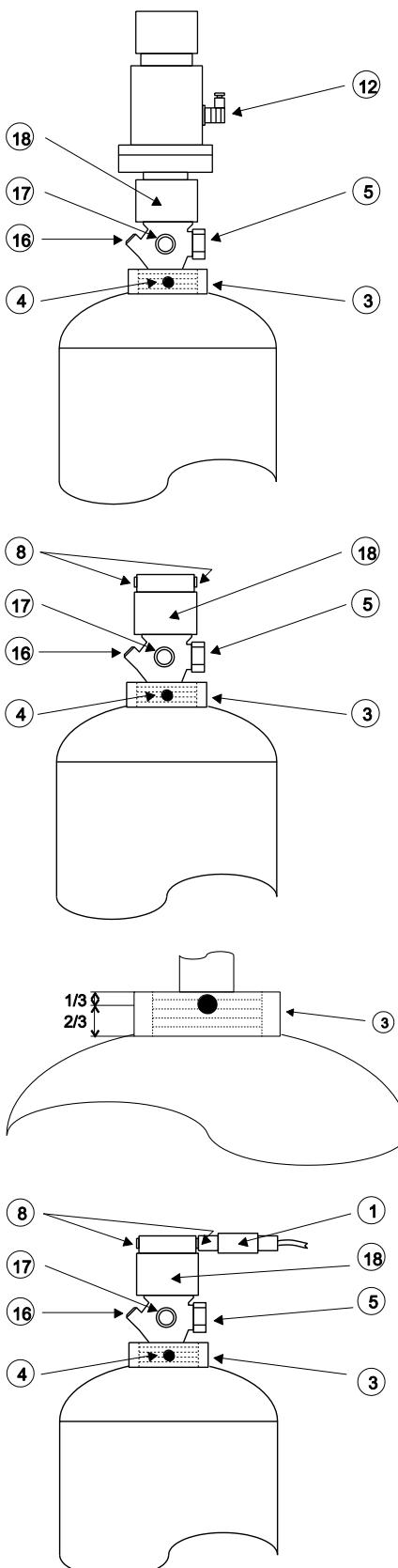
Ventily B480 jsou aktivovány elektrickými resp. pneumatickými spouštěči na ventilu. Elektrický spouštěč musí být po aktivaci resetován rozpínacím zařízením. Jinak se ventil při montáži spouštěče okamžitě aktivuje.
