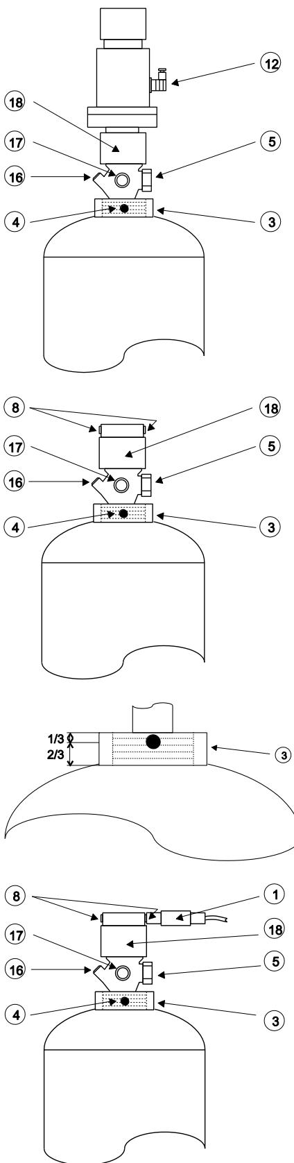
Les vannes B480 sont commandées par des dispositifs de déclenchement électriques ou pneumatiques situés sur la vanne. Le dispositif de déclenchement électrique doit être réarmé avec le dispositif de tension après un déclenchement. Sinon, la vanne est immédiatement activée lors du montage du dispositif de déclenchement.
