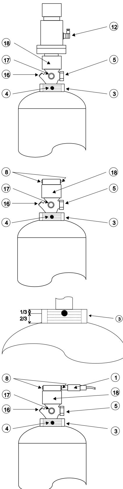
Ventily B480 sa ovládajú elektrickými, resp. pneumatickými spúšťačmi na ventile. Elektrický spúšťač sa po spustení musí resetovať pomocou napínacieho zariadenia. Inak sa ventil pri montáži spúšťača okamžite aktivuje.
