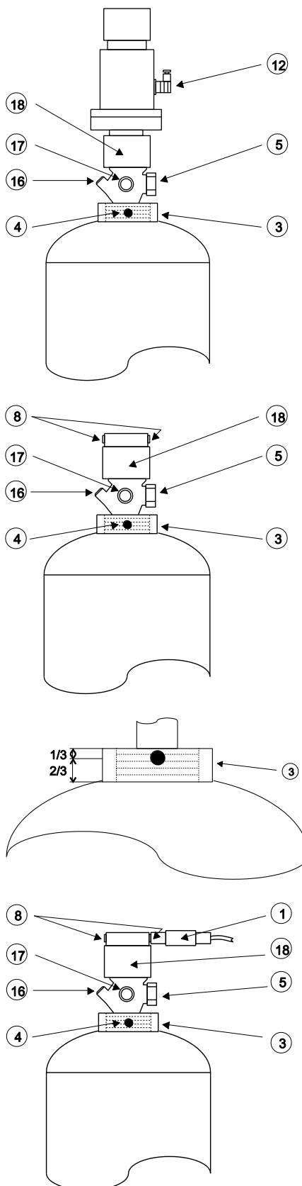
Le valvole B480 sono azionate mediante dispositivi di azionamento elettrici o pneumatici posti sulla valvola. Il dispositivo di azionamento elettrico deve essere ripristinato dopo un intervento per mezzo del dispositivo di serraggio. In caso contrario la valvola si attiva immediatamente al momento del montaggio del dispositivo di azionamento.
