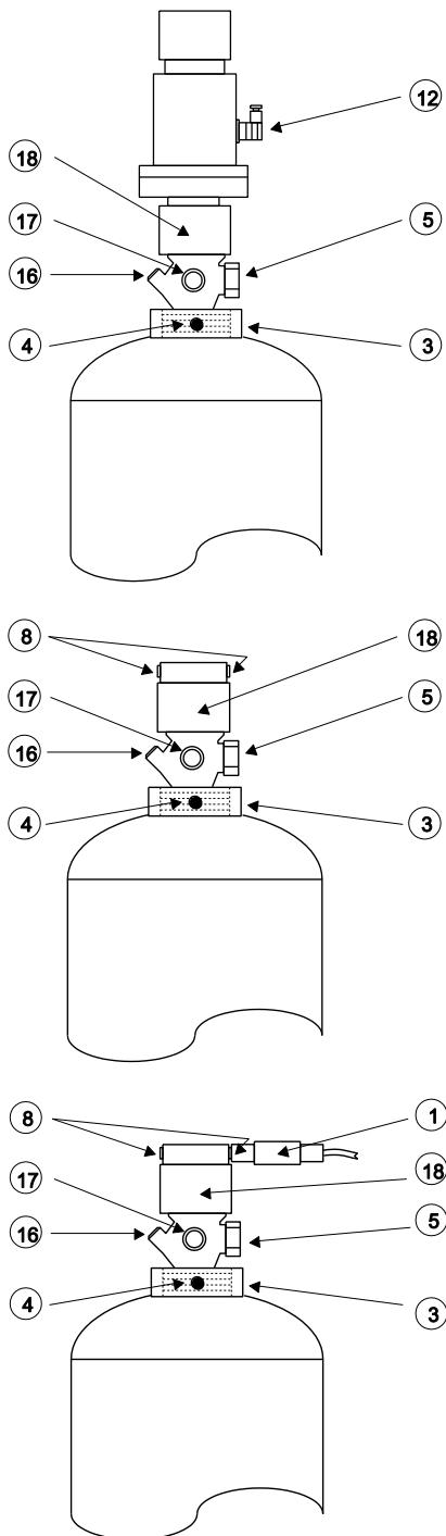
Die Ventile B480 werden durch elektrische bzw. pneumatische Auslöser auf dem Ventil angesteuert. Der elektrische Auslöser muss nach einer Auslösung mit der Spannvorrichtung zurückgestellt werden. Ansonsten wird das Ventil bei der Montage des Auslösers sofort aktiviert.
