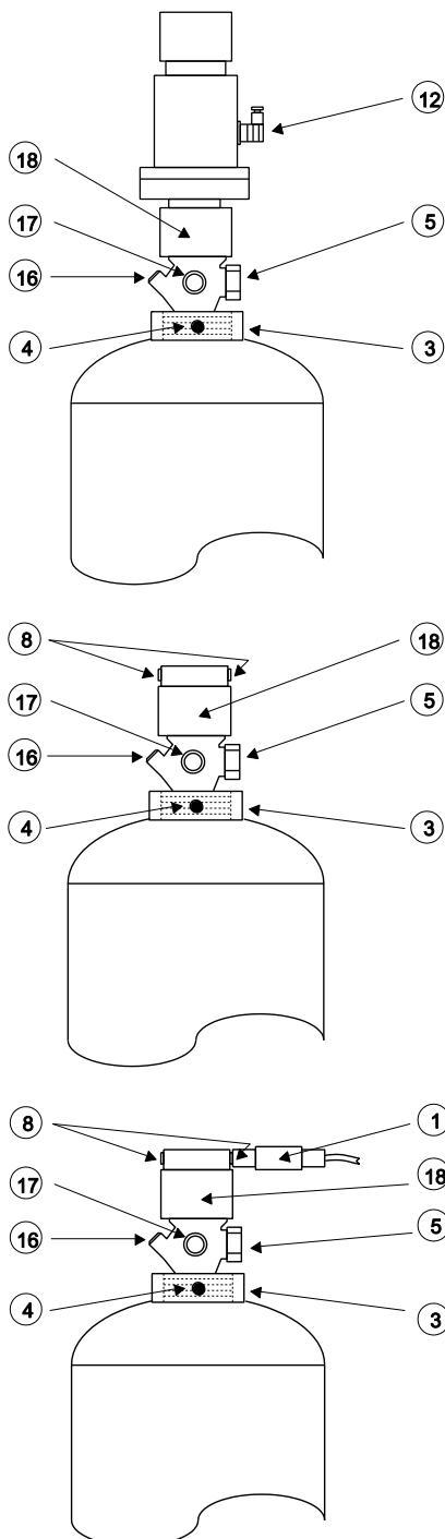
Ventily B480 sa ovládajú elektrickými, resp. pneumatickými spúšťačmi na ventile. Elektrický spúšťač sa po spustení musí resetovať pomocou napínacieho zariadenia. Inak sa ventil pri montáži spúšťača okamžite aktivuje.
