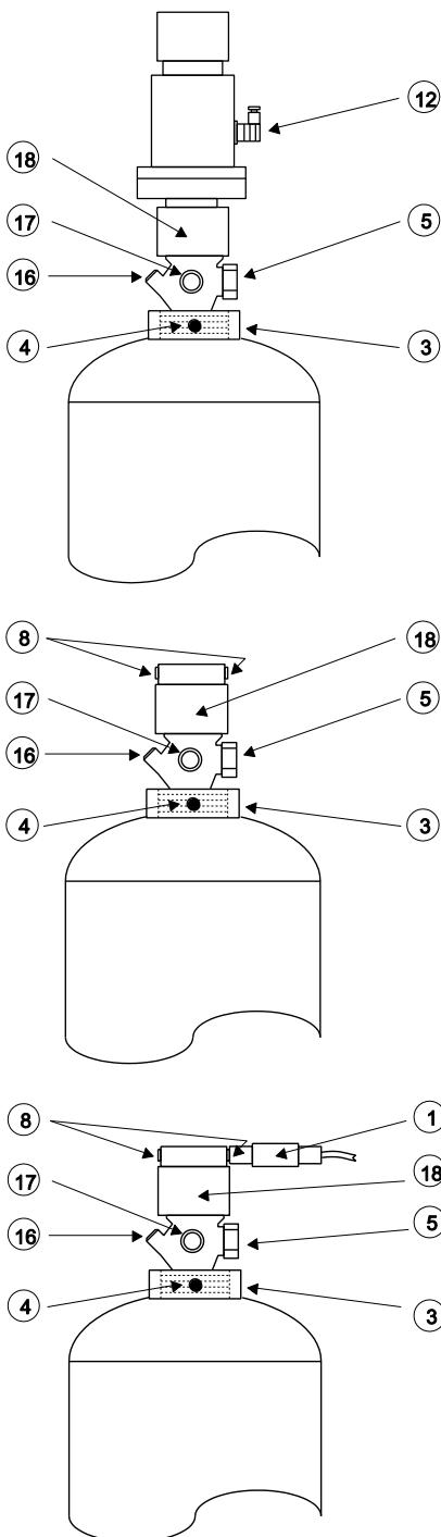
Les vannes B480 sont commandées par des dispositifs de déclenchement électriques ou pneumatiques situés sur la vanne. Le dispositif de déclenchement électrique doit être réarmé avec le dispositif de tension après un déclenchement. Sinon, la vanne est immédiatement activée lors du montage du dispositif de déclenchement.
