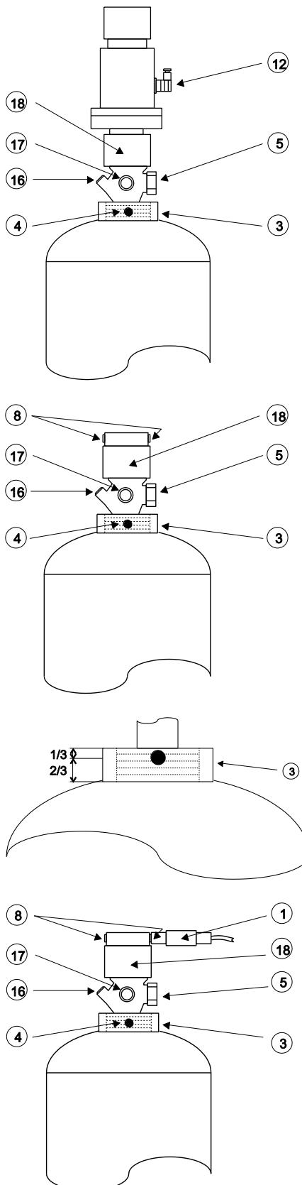
Die Ventile B480 werden durch elektrische bzw. pneumatische Auslöser auf dem Ventil angesteuert. Der elektrische Auslöser muss nach einer Auslösung mit der Spannvorrichtung zurückgestellt werden. Ansonsten wird das Ventil bei der Montage des Auslösers sofort aktiviert.
