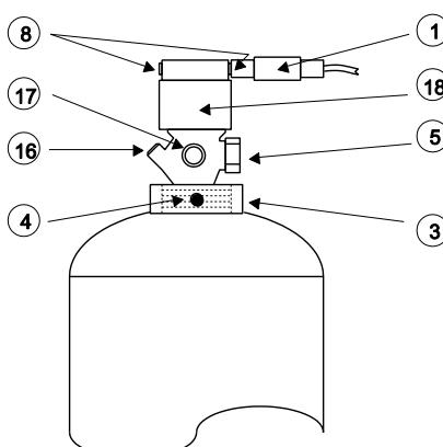
Ventily B480 jsou aktivovány elektrickými resp. pneumatickými spouštěči na ventilu. Elektrický spouštěč musí být po aktivaci resetován rozpínacím zařízením. Jinak se ventil při montáži spouštěče okamžitě aktivuje.
